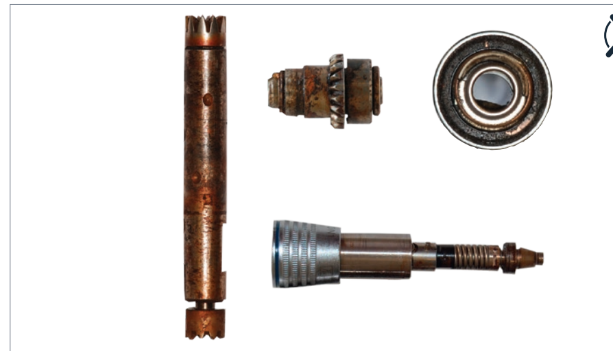
Запчасти бывших в использовании наконечников, обслуживание которых проводилось регулярно и по правилам
