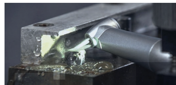
Проверка надежности фиксации бора при нагрузке более 3 кг
