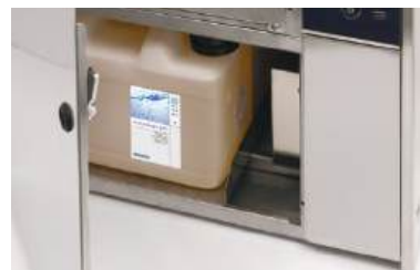
Система дозирования для дезинфицирующих средств
