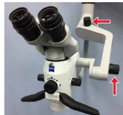
Тормоза осей 5 и 6 для фиксации положения микроскопа
