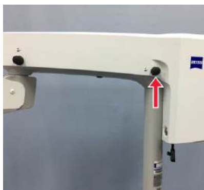
Тормоз оси 1 для фиксации держателя
