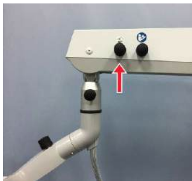
Тормоз оси 3 для фиксации балки подвеса в вертикальном положении
