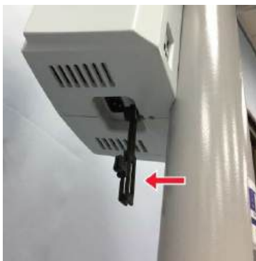
Устройство разгрузки натяжения для предотвращения непреднамеренного отключения кабеля
