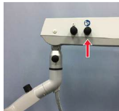
Тормоз для установки самого нижнего положения балки подвеса
