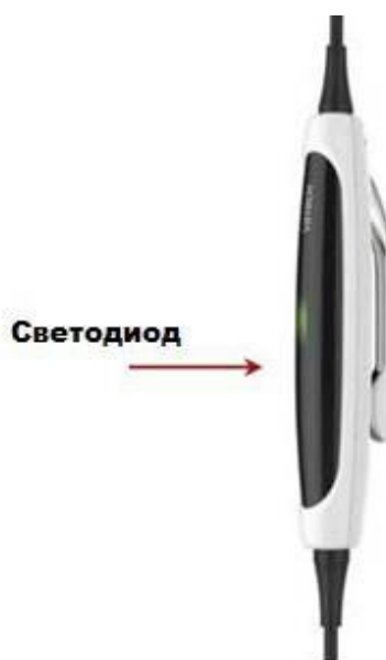
Расположение светодиодов на блоке интерфейсной платы
