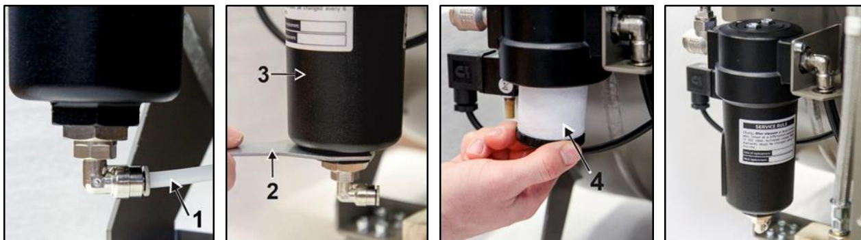
Obr. 19: Výměna filtrační vložky ve filtru
