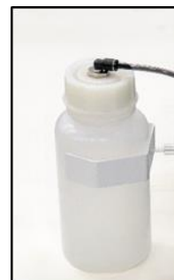
Рис. 16: Проверка резервуара для сбора конденсата
