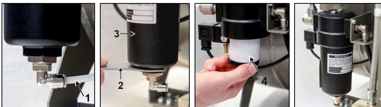
Rys. 19: Wymiana elementu filtracyjnego
