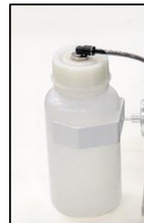
Abb. 16: Überprüfen des Kondensatauffangbehälters
