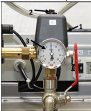
Abb. 23: Schalten des Kompressors
