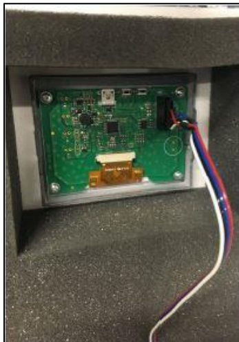
Fig. 17: Branchement du connecteur de l'écran
