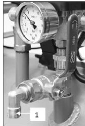
Рис. 8: Подключение к выпускному воздухопроводу сжатого воздуха
