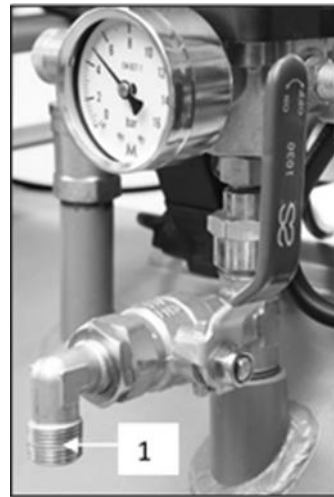
Abb. 8: Anschluss an den Druckluftausgang
