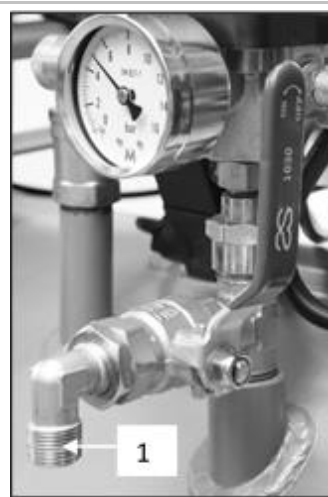
Obr. 8: Pripojenie k výstupu stlačeného vzduchu
