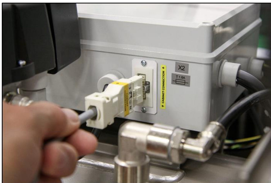
Obr. 13: Zapojení skříňky ke kompresoru
