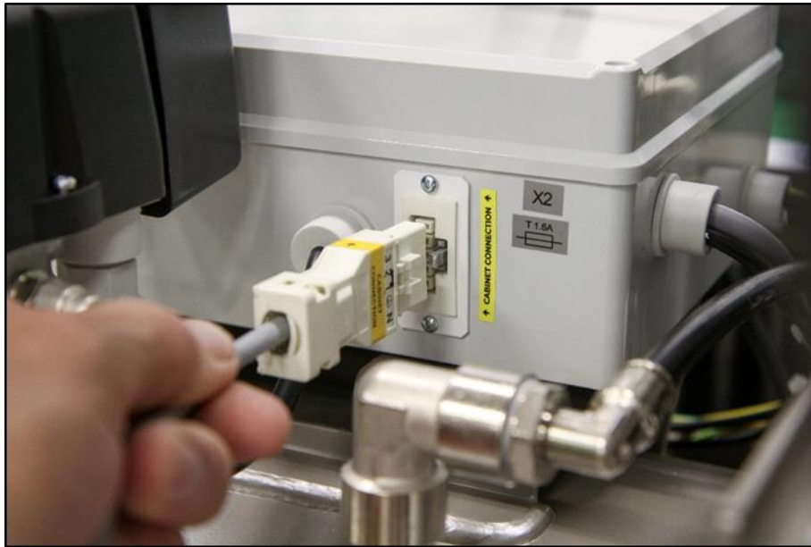
Abb. 13: Anschließen des Gehäuses an den Kompressor
