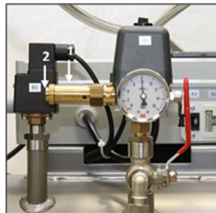
Rys. 25: Kontrola zaworu bezpieczeństwa
