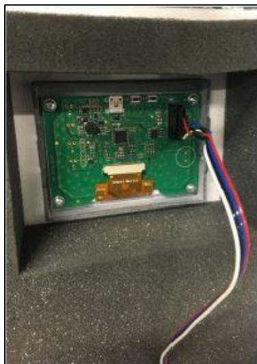
Рис. 17: Подключение разъема дисплея
