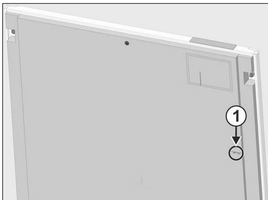
Fig. 18: Position des pinces dans l'armoire DK50 4VR/50 S/M
