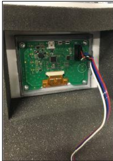
Rys. 17: Podłączenie złącza wyświetlacza
