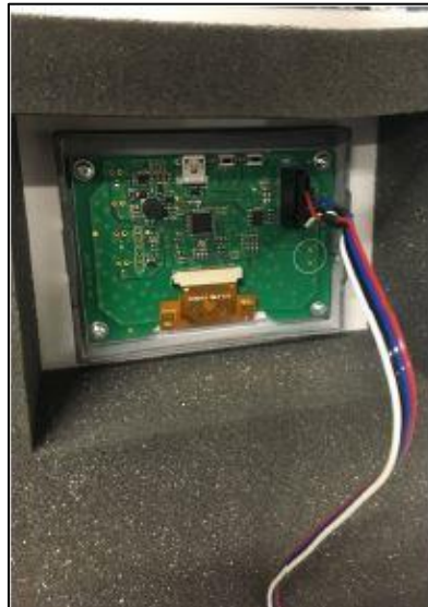
Abb. 17: Anschließen des Displaysteckers
